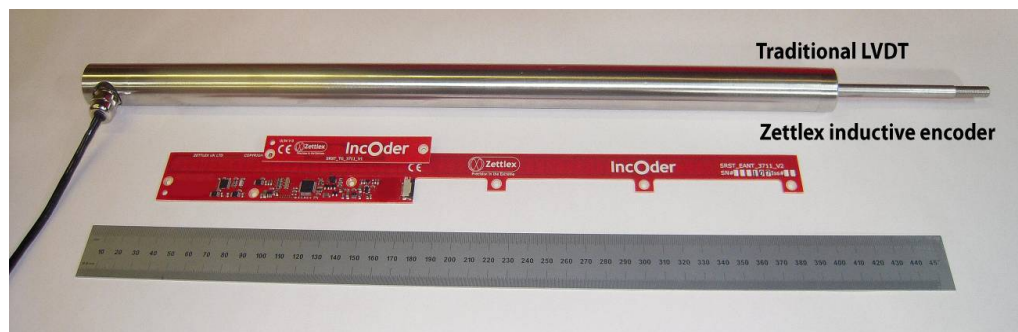
従来の LVDT（上）と Zettlex のリニアセンサ（中）。比較用定規（下）
