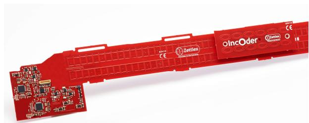
図 1 - 回転角度センサと直線センサ
