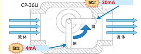
机器上安装状态下，仍可调整输出信号。
