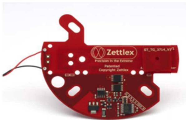
電子回路モジュールは、電圧と逆極性保護(必要な場合)、送信回路(発振器を含む)、受信回路は、マイクロコントローラと電気出力、電源を備えています。Zettlex特定用途向け集積回路を用いた例が右に示されています。一般的な電源は、3.3、5、10、12、24、28Vです。
