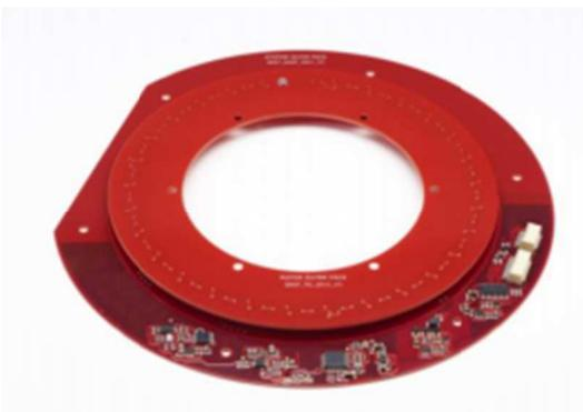
ステータは、通常、送信および受信回路を形成する導体の平面に配置されています。回路は、ステータの測定軸に沿って、あるいは交差して配置されています。
