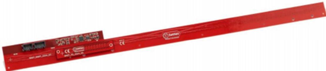
AC信号で通電すると、ステータはローカル電磁界を生成します。ターゲットがフィールドに入ったとき、それはターンにおいて、ステータによって感知され、摂動を引き起こします。この摂動信号は、電子回路モジュールによって処理されます。電子回路モジュールはその後ステータの測定軸に沿ったターゲットの位置に相似した信号を出力します。
