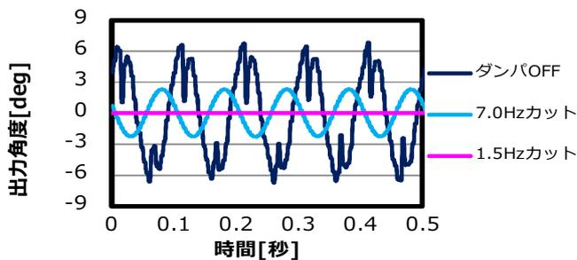
傾斜計測に最適なデジタルフィルタを実装済みのため、周波数応答性を16段の中から自由に選択可能であり、振動環境下でも傾斜角を正しく計測できます。
